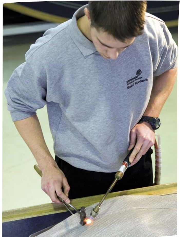
Les ventes d'Umicore de toiles catalytiques au platine ont augmenté au cours de l'année. Daniel Bordsch contrôle la finition d'une toile à Hanau, Allemagne.
