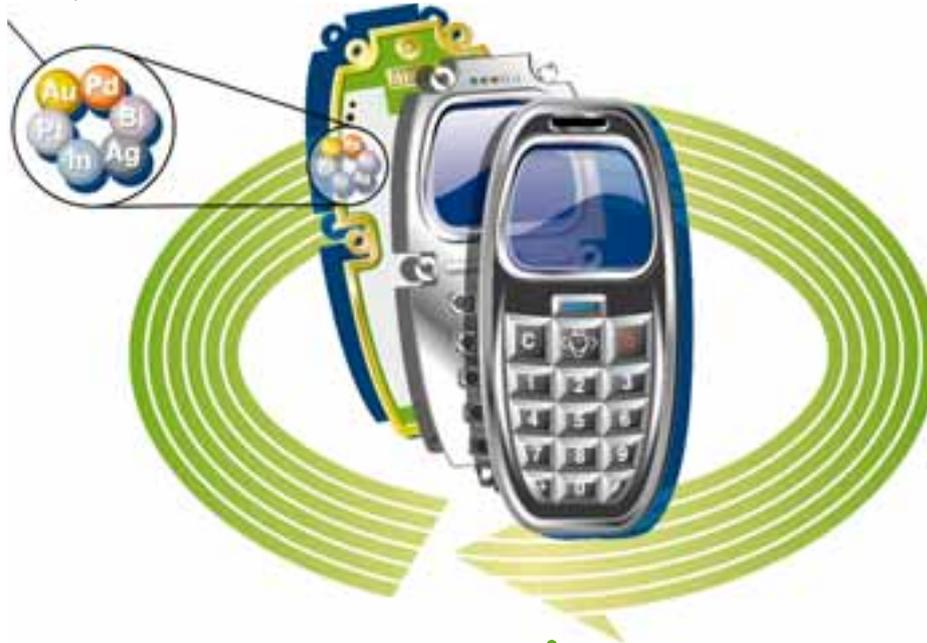
Les vieux téléphones portables contiennent des métaux précieux tels que l'argent (Ag), l'or (Au) ou le palladium (Pd) que les opérations complexes de recyclage et de raffinage d'Hoboken sont capables de récupérer. En moyenne, 50 000 téléphones portables contiennent environ 1 kilo d'or et 10 kilos d'argent. Environ 1 % seulement de tous les téléphones portables mis à la poubelle tous les ans sont recyclés. Ce nouveau type de « mine » possède donc un potentiel d'exploitation énorme.
